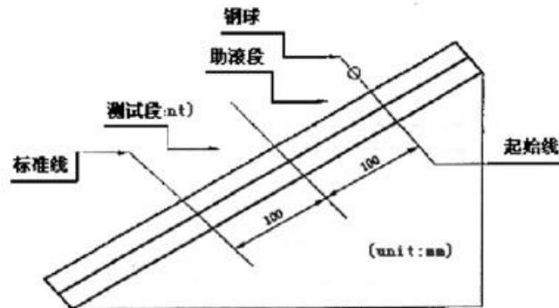
B 法：将一规定大小的钢球滚过倾斜槽，测量其在水平板上的胶粘带粘性面上滚动的距离来评价其初粘性的大小。
